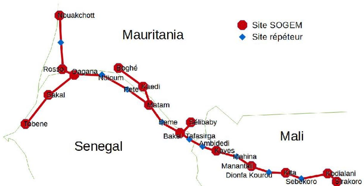
Figure 15 - Topologie du réseau SOGEM
